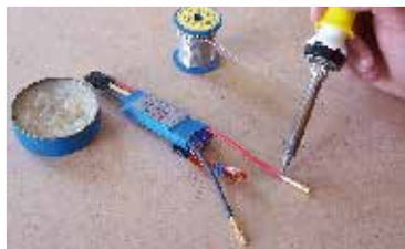
135. K vodičům regulátoru připájíme konektory... Solder connectors to the speed controller wires ...
