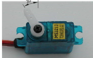
47. Správná poloha páky serva v neutrálu - platí pro servo klapky Correct position of the servo arm in centre - apply to flaps servo.
