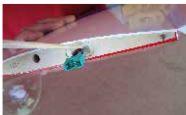
62. Pomocí zahuštěného 5 min. epoxi vlepíme konektor do vnější části křídla... Glue connector to the outer side of the wing, use thicken 5-min EPOXI ...
