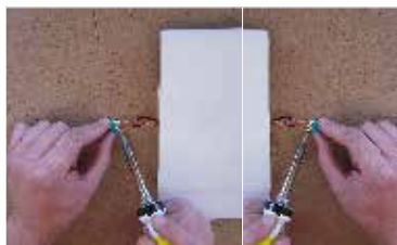
39. Na vystupující kabely připájíme konektory ("MULTIPLEX"-6 kolíků) Solder connectors (MULTIPLEX 6-pin) on the stand out cables.
