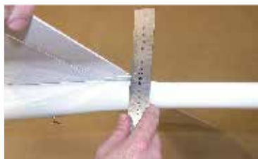
188. Výhyčka klapky nahoru = 3mm... Flaps deviation up = 3 mm ...
