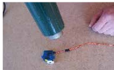
42. ... a smrštíme bužírku ... and shrinking tubes.
