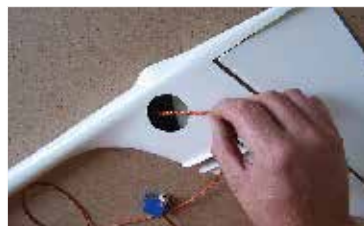
129. Kabel serva výškovky vsuneme do trupu... Insert elevator servo cable to the fuselage ...
