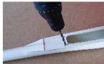
102. ...otvory převrtáme na Ø6,2mm, dbáme na dodržení směru vrtání a souososti obou otvorů... ... redrill holes Ø 6.2 mm, be sure correct orientation and collinearity for both holes ...
