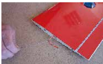
40. Rozpůlíme, odizolujeme a pocínujeme kabel serv křídélkem... Halve servo cable for ailerons, cut insulate and solder wires ...
