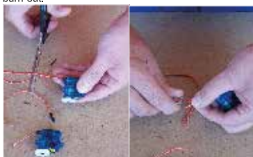
40. Rozpůlíme, odizolujeme a pocínujeme kabel serv křídélkem... Halve servo cable for ailerons, cut insulate and solder wires ...
