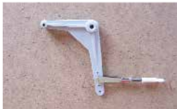
119. Táhlo připojíme k páce výškovky #3-8 Connect pushrod to elevator arm #3-8.
