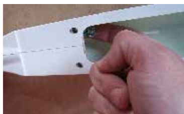
103. ...vtlačíme matice #2-3... ... stuff nuts #2-3 ...
