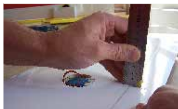
72. Předchozí operace opakujeme i s pákou druhé klapky (snažíme se dodržet stejnou polohu) Repeat previous steps for second flap arm (try fixed same position of the arm).
