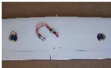
53. Stejným způsobem nainstalujeme i druhé servo klapky Install second flap servo, use same method.
