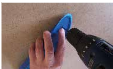
79. ...vyvrtáme otvor Ø3mm ... ... drill hole ø 3 mm ...
