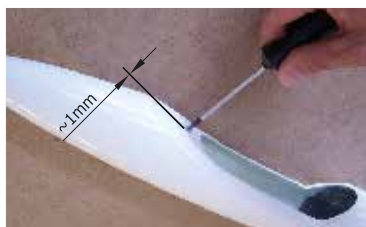
76. ... zašroubojeme vrtu #6-1 ... screw on wood screw #6-1.
