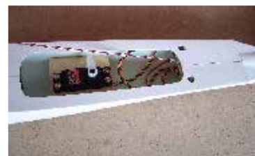
158. Do "vedení" táhla vsuneme táhlo #4-5... Insert pushrod #4-5 to the linkage ...
