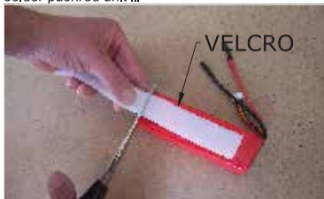
184. K upevnění akumulátorů použijeme např. suchý zip Use dry zipper as battery holder for example.
