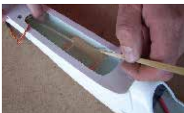
148. ...lehce přetřeme lepidlem... ... coat fine glue film.
