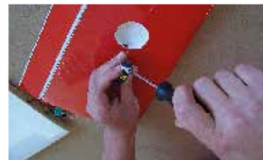
56. Nasadíme páku a přišroubujeme ji Fit and screw servo arm on the servo.
