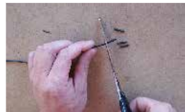
114. ...připravíme si bužírku... ... prepare insulate tubes ...
