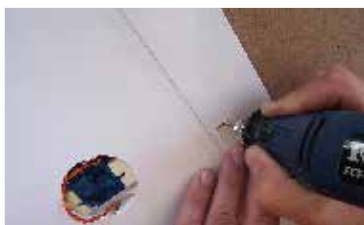
69. ...vyfrézujeme drážku... ... shape slot for arm ...
