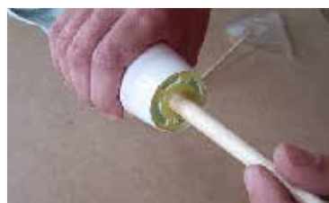
107. ...zkontrolujeme její polohu, popř. vnitřek trupu zabrousíme... ... test position of the motor wicket, finish fuselage inside when requirement ...
