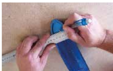
77. Na vnitřní straně kabiny #6 si naměříme střed... Measure central point on inside part of the cockpit #6 ...
