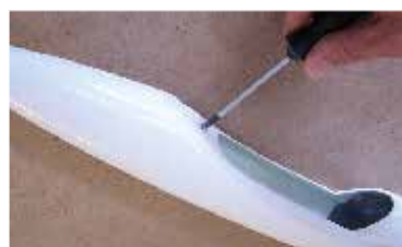
83. ...zašroubování / vyšroubováním vrtu #6-1 ... doladíme zajištění kabiny na trupu ... adjust look of the cockpit by screw on/screw off wood screw #6-1.
