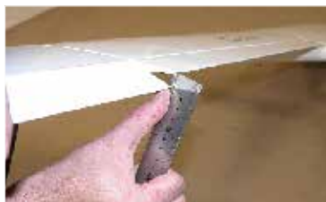
190. Křídélka dolů = 10 - 15mm... Ailerons down = 10 - 15 mm ...
