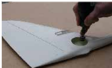
88. ...otvor začistíme ... finish hole.
