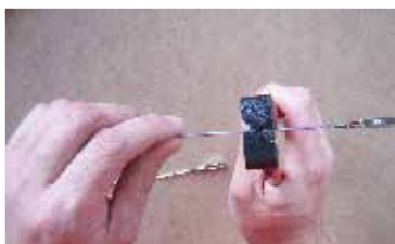
81. ...na táhlu #2-5 vytvoříme "Z" ohyb... ... form curve "Z" on the pushrod #2-5 ...
