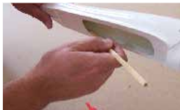
96. Do trupu, v místě, kde budou matice křídla #2-3, nanese me zahuštěný 30 min. epoxi... Put thickened 30-min EPOXI to place for wing nut #2-3.
